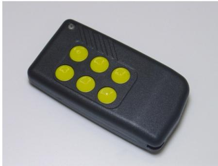
Die Fernbedienung wird mit einer Batterie Typ CR2032 betrieben. Zum Wechseln der Batterie muss der mit einer Kreuzschlitzschraube befestigte Deckel entfernt werden.
